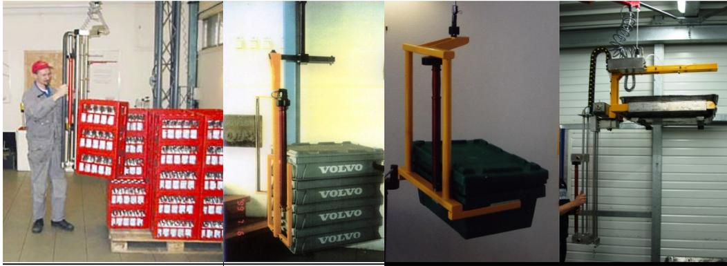
Les préhenseurs de bacs plastiques permettent la prise en toute sécurité et une manipulation plus aisée des produits. Des mouvements peuvent être associés dans le cadre de l'action de l'opérateur → levage du bac, inclinaison ou rotation totale des bacs.
